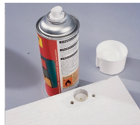
6 Naprawione miejsce będzie mniej widoczne, jeśli pokryjemy je farbą o odpowiednio dobranym kolorze.
