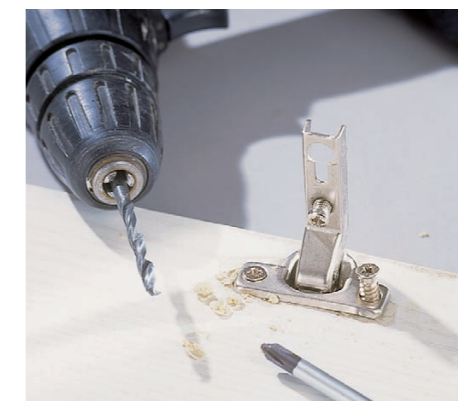
7 Otwory na wkręty do zamocowania zawiasu należy nawiercić wiertłem o średnicy nieco mniejszej od grubości zastosowanych wkrętów.
