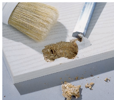
1 Uszkodzone drzwiczki. Luźne i popękane fragmenty należy usunąć dłutem, a z powiększonego otworu pędzlem wymieść wióry i pył.
