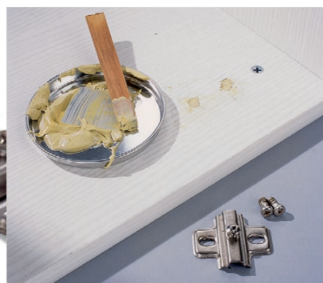
A Uszkodzony korpus. Jeśli wylamane zostały otwory wkrętów do mocowania płytek montażowych, wypełniamy je pastą do drewna.
