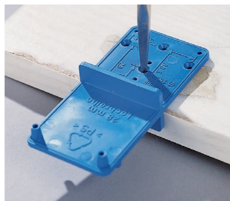
4 Postępując się szablonem do wiercenia otworów, oznaczamy kolcem wynoszący 21,5 mm odstęp wierconego otworu od krawędzi drzwiczek.
