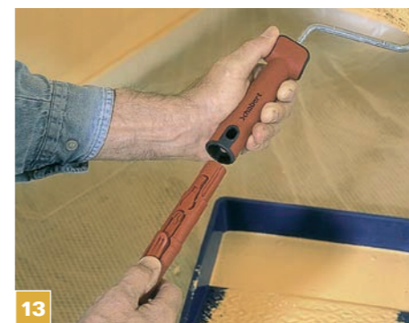
13 Malowanie wysokich ścian ułatwi teleskopowy drążek z aluminium (z połączeniem bagnetowym), który można rozsunąć na długość do 3 m.
