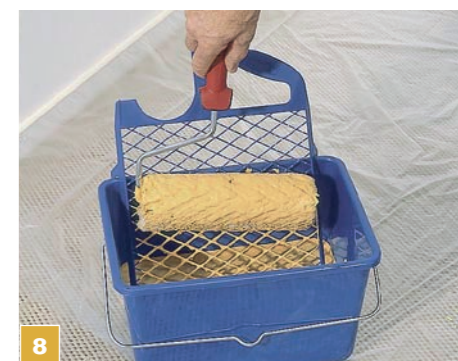
8 Farbę przelewamy do wiadra. Po zanurzeniu wałek przetaczymy kilka razy po kratce zbierającej nadmiar farby, dzięki temu nie będzie kapać.
